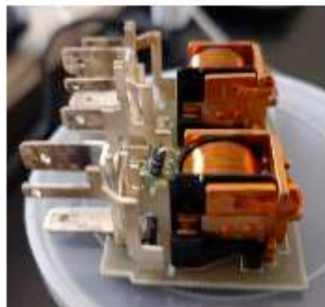
Figure 2 : Double relais Bosch sorti de son capot
