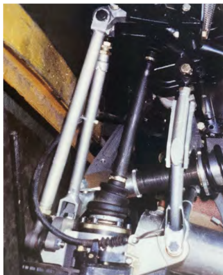
Styrearmen til det medstyrende baghjulsophæng ses i midten.
