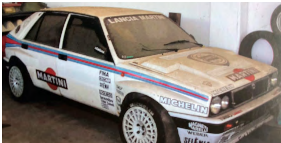
Lancia Delta Integrale 4WS prototypen. I forhold til Integrale 8V og 16V ses tydeligt de bredere skærme og den modificerede motorhjelme med ekstra "buler" til de hævede støddæmpertårne
