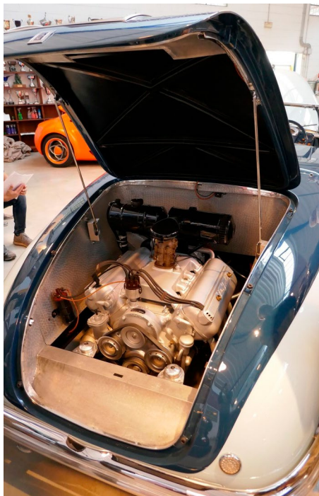
Isotta Fraschini 8C Monterosa 1948 var udstyret med en 8-cylindret hækmotor
