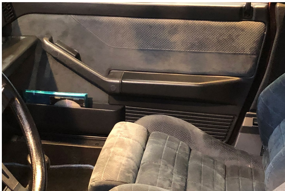
Højre fordør med løst hængende beklædning, der er ikke rigtigt modstand når man trykker midt på døren
