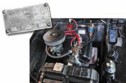
Lille og kompakt - Motor er 4 cylindret i V-form, som i en Berlina. Topventilet og med 2 knastaksler.
