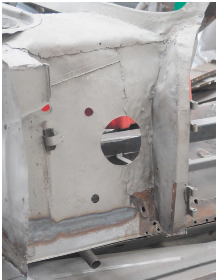
Zagatos pladearbejde under overfladen er berygtet. Her en Flaminia
