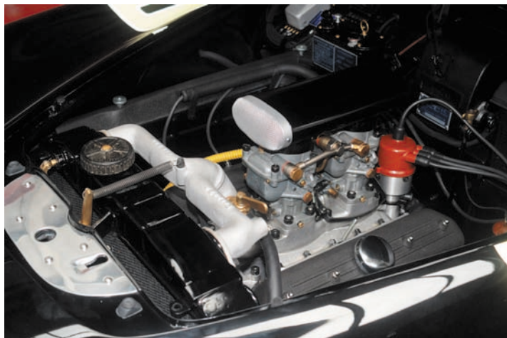
Motoren i Braccos Aurelia. 2 liter og 2 karburatorer
