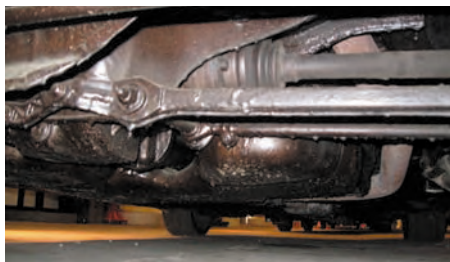
Undervognsbehandling i rigelige mængder
