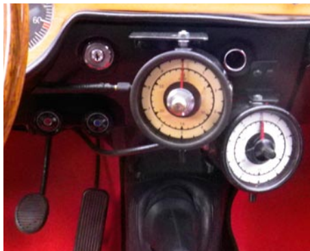
Foto: Per Manstrup Kristensen - Arne's smukke Hemo'er, det er triptællere der benyttes i pålidelighedsrally.
