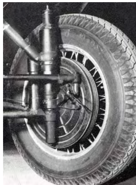
Lambdas forhjulsaffjedring var monteret i en rørgitterramme
